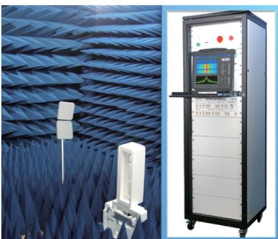
图3 聚星仪器RFID综合测试仪和微波暗室测试现场
